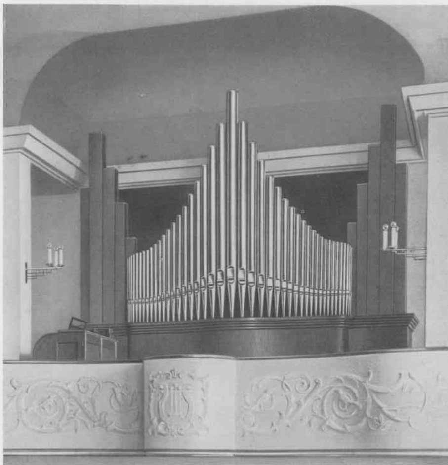
BENSBERG, NEUES PRIESTERSEMINAR ORGEL 24 Register, 2 Manuale, elektrische Bauart und Windversorgung erbaut im Auftrage Sr. Eminenz Kardinal Schulte, Erzbischof von Köln
